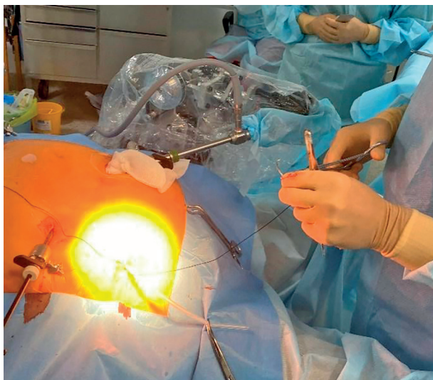
Рисунок 2 – Использование устройства управления хирургической камерой во время операции
